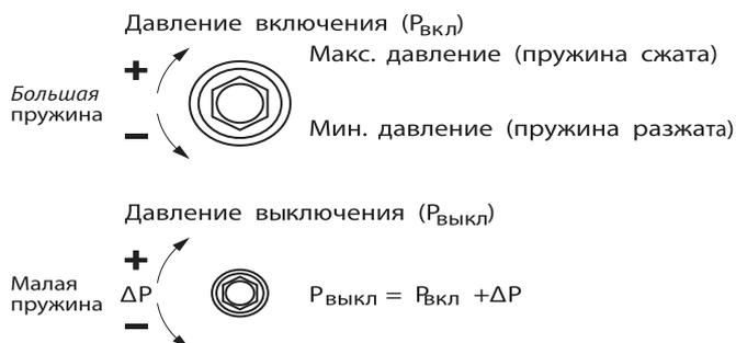
Для настройки давления включения  $P_{\text{вкл}}$  и выключения  $P_{\text{выкл}}$ :
