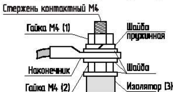
Рис.8 Присоединение проводов к выводам блок ТЭН
