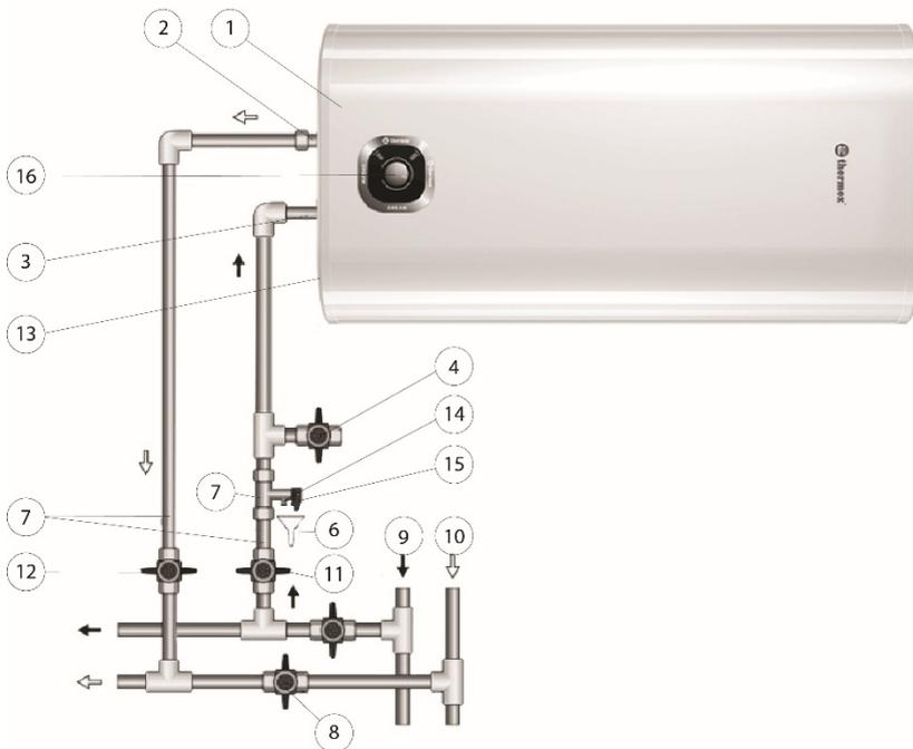
**Рисунок 1:** 1 – ЭВН, 2 – патрубок горячей воды, 3 – патрубок холодной воды, 4 – сливной вентиль, 5 – предохранительный клапан, 6 – дренаж в канализацию, 7 – подводка, 8 – перекрыть вентиль при эксплуатации ЭВН, 9 – магистраль холодной воды, 10 – магистраль горячей воды, 11 – запорный вентиль холодной воды, 12 – запорный вентиль горячей воды, 13 – защитная крышка, 14 – выпускная труба предохранительного клапана, 15 – ручка для открывания предохранительного клапана, 16 – панель управления.
