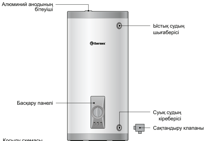
1 сур. Қосылу схемасы
