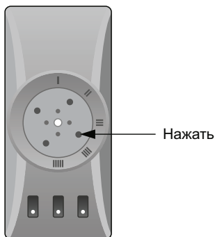
Рис. 3. Расположение штока на термовыключателе термостата.
