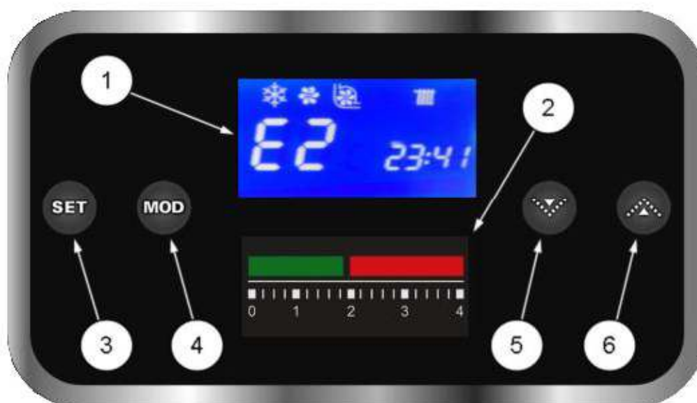
Рис. 6 Панель управления котлом
