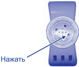
Рис.2. Расположение штока на термовыключателе термостата
