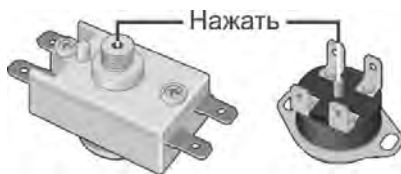
Рисунок 3. Схема расположения кнопки термовыключателя
