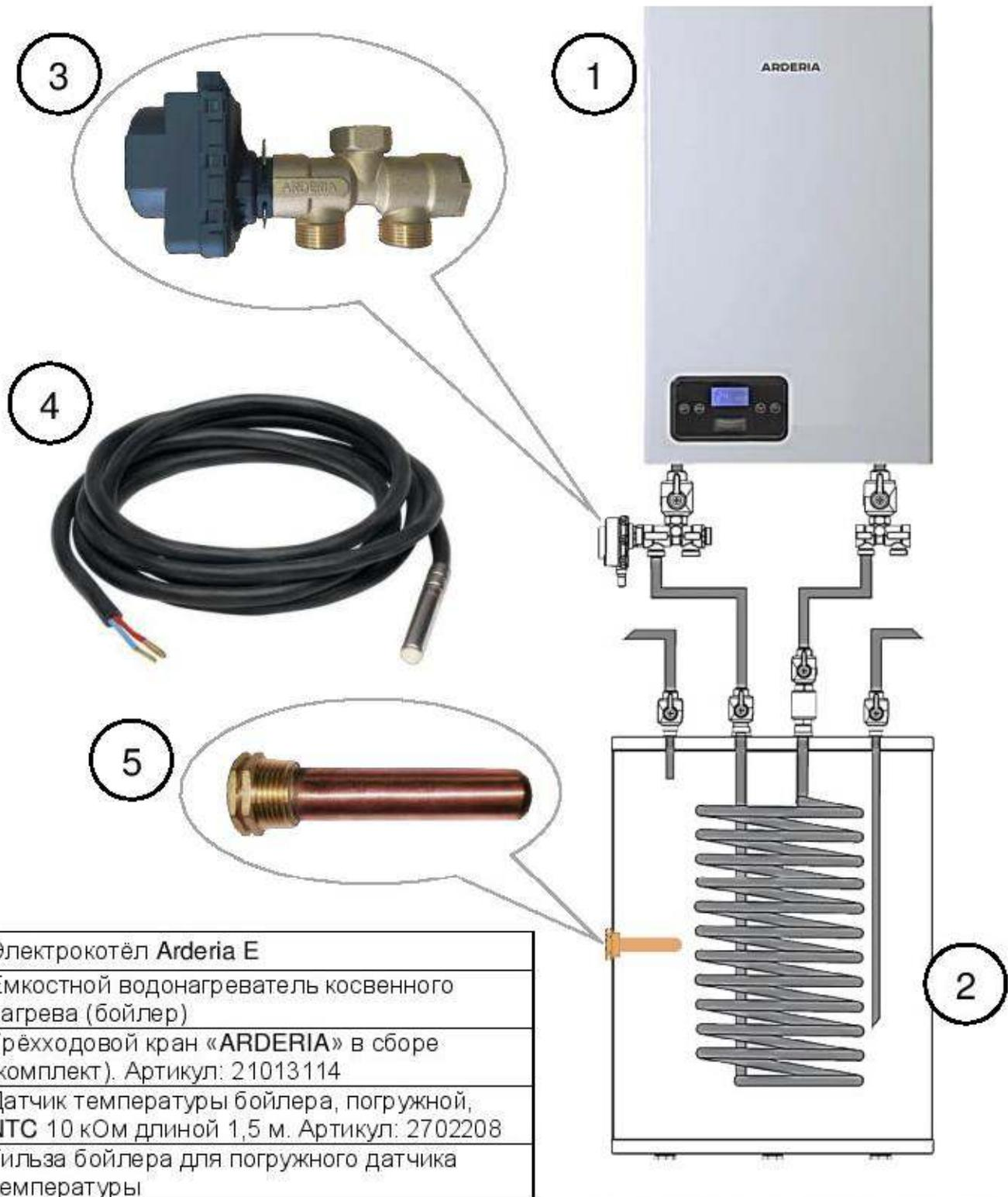
Рис. 22 Принципиальная монтажная схема подключения электрокотла к емкостному водонагревателю косвенного нагрева (бойлеру)
