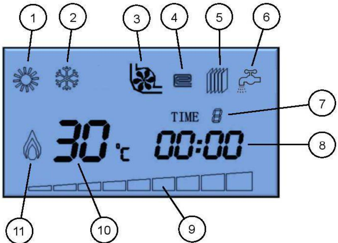
Рис. 7 ЖК-дисплей панели управления электрокотлом
