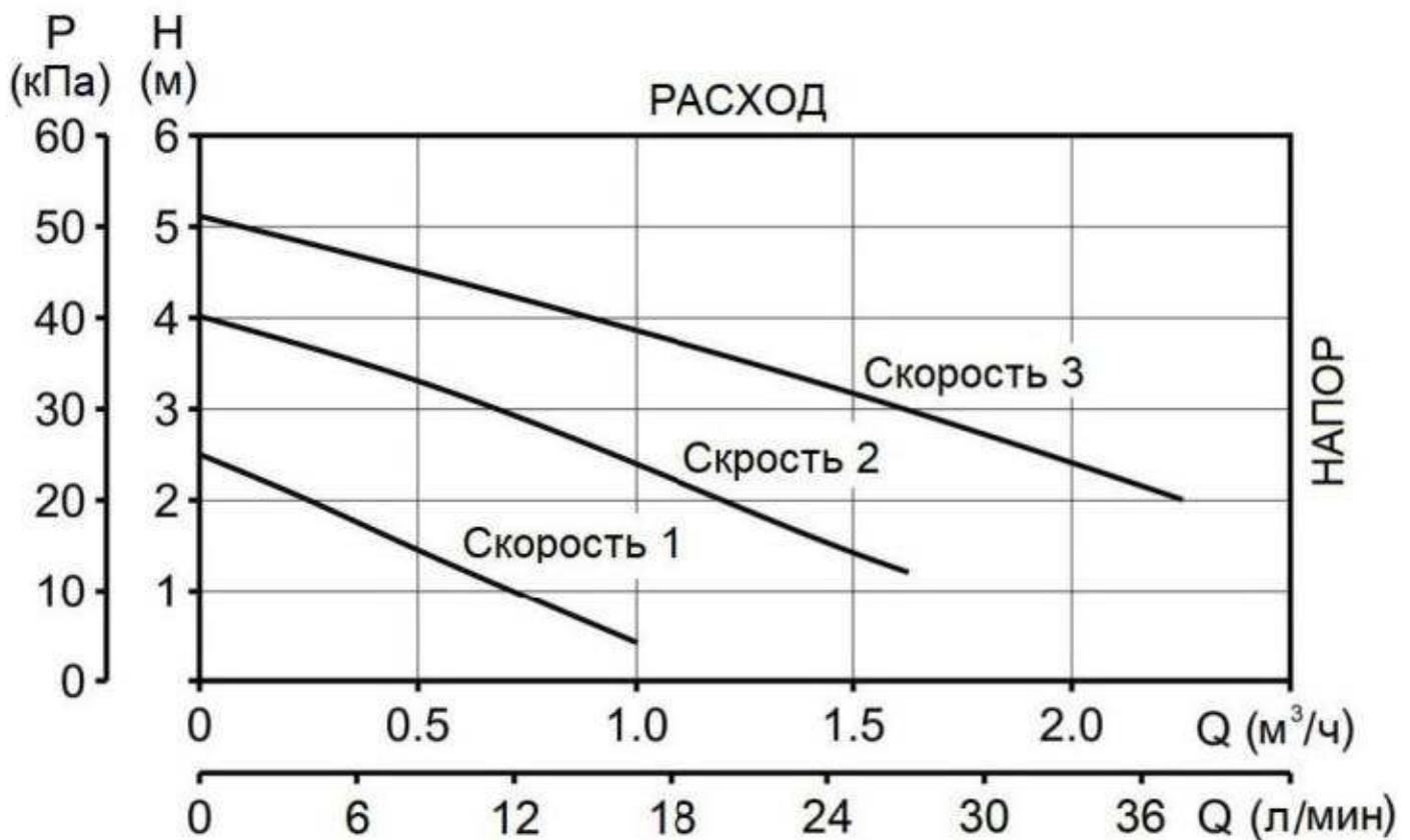
Рис. 20 Напорно-расходные кривые циркуляционного насоса электродкотла.
