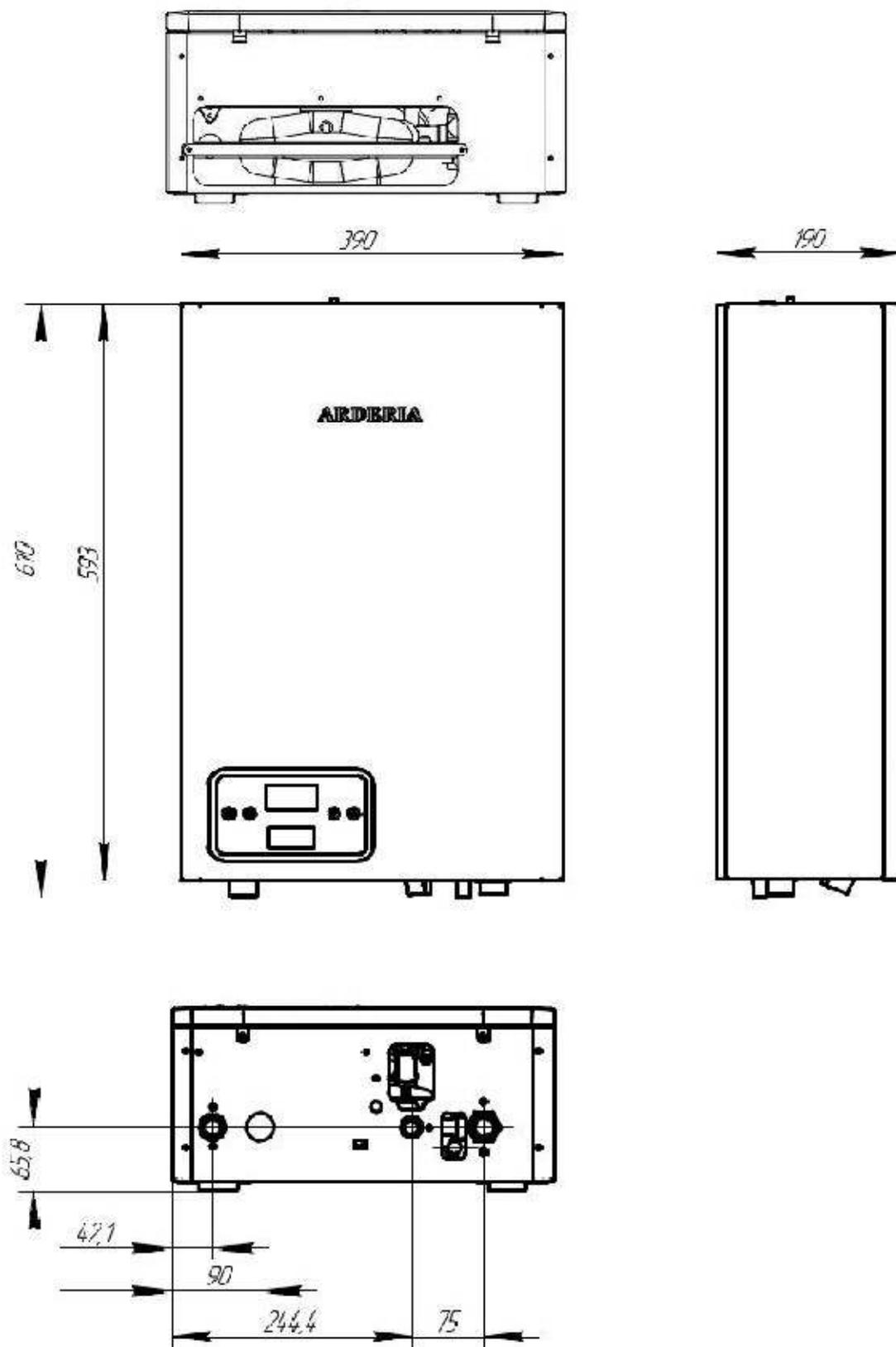
Рис. 3 Габаритные размеры
