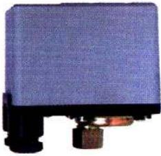
Однофазное реле давления для насосов со сменной мембраной. Автоматически регулирует работу электронасосов системы водоснабжения или отопления в соответствии с установленными значениями давления. При минимальном установленном значении обеспечивается замыкание контактов реле и, следовательно, включение насоса. Когда давление достигает максимального установленного значения, контакты размыкаются, что приводит к остановке насоса.
