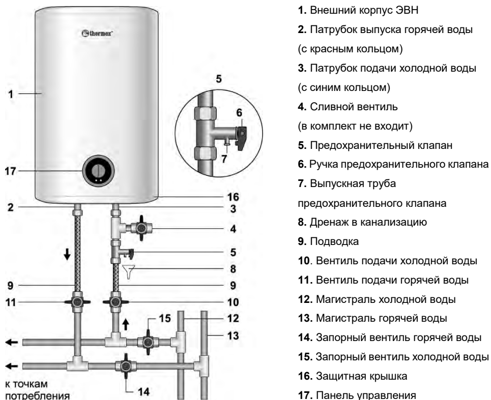
Рисунок 2. Схема подключения ЭВН к водопроводу
