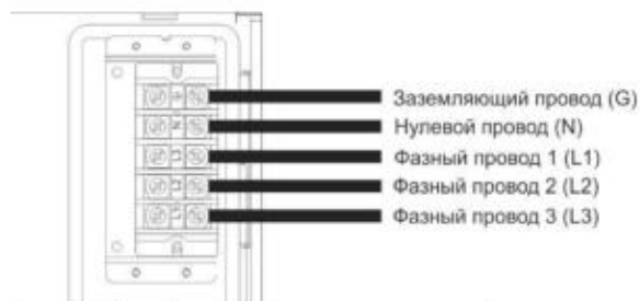
Рис 12. Трехфазное подключение прибора
