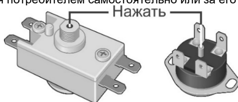
Рисунок 5. Возможные схемы расположения кнопки термовыключателя
