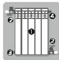
Диагональное (рекомендуется для получения максимальной теплоотдачи)
