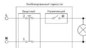
Рис. 9. Схема электрическая для моделей S-series
