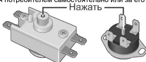
Рисунок 5. Возможные схемы расположения кнопки термовыключателя
