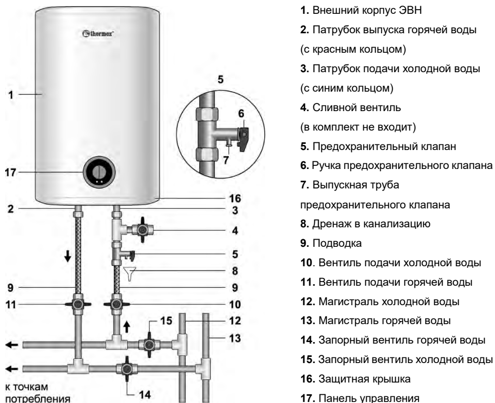
Рисунок 2. Схема подключения ЭВН к водопроводу
