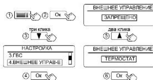
Рисунок 19. Настройка работы от внешнего устройства
