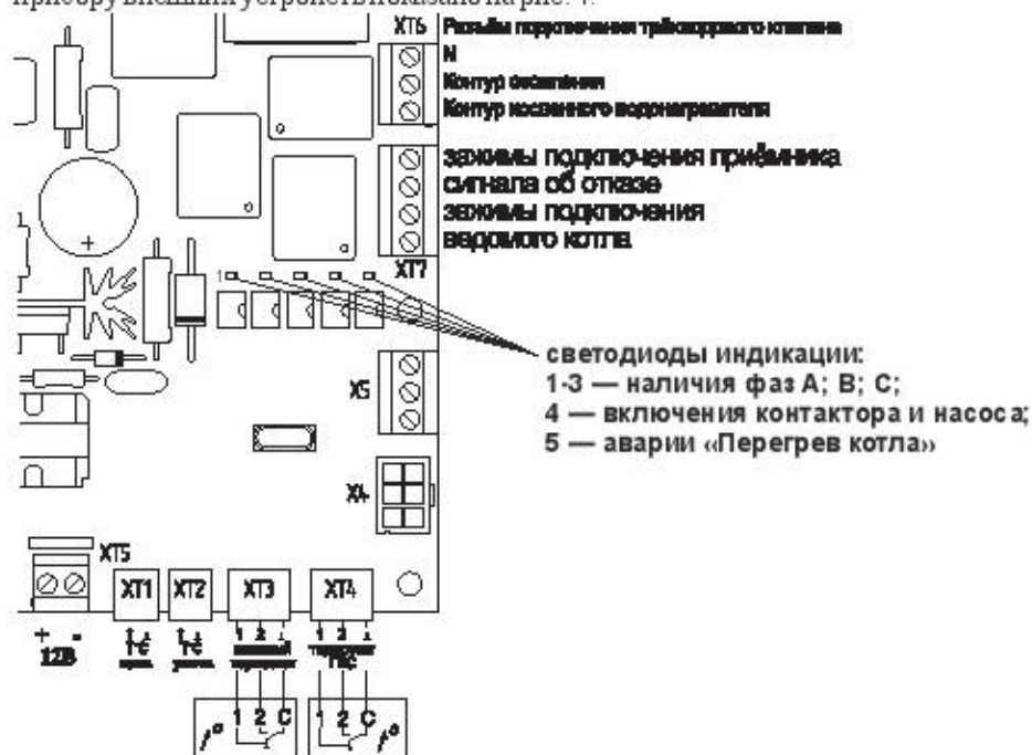
Рисунок 4. Расположение на плате управления разъемов для подключения внешних устройств.
