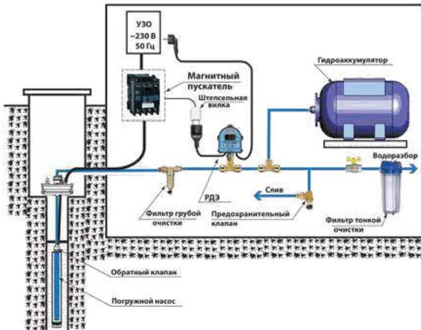
Пример 5. Подключение РДЭ-К для управления погружным насосом.
