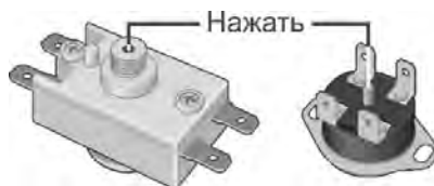
Рисунок 3. Схема расположения кнопки термовыключателя
