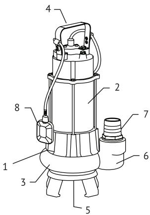
Насос представляет собой моноблочный агрегат, корпус которого разделен на гидравлическую часть (1) и электродвигатель (2). Однофазный асинхронный электродвигатель с пусковым конденсатором размещен в закрытом от попадания жидкости кожухе из нержавеющей стали.
