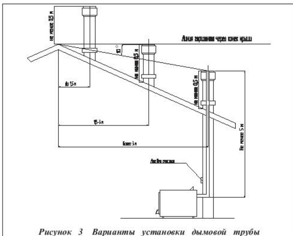
Рисунок 3 Варианты установки дымовой трубы
